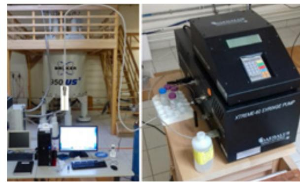
■ Dispositif expérimental de mise sous pression. L'échantillon est positionné dans le tube en zirconium au cœur du spectromètre RMN (ici le 950 MHz de l'ICSN). La mise sous pression est effectuée par la pompe et la ligne de transfert, représentée ici schématiquement, transfère la pression au tube RMN. (© F. Giraud)
