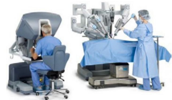
■ Système de téléchirurgie robotique Da Vinci (courtesy of Intuitive Inc.)
